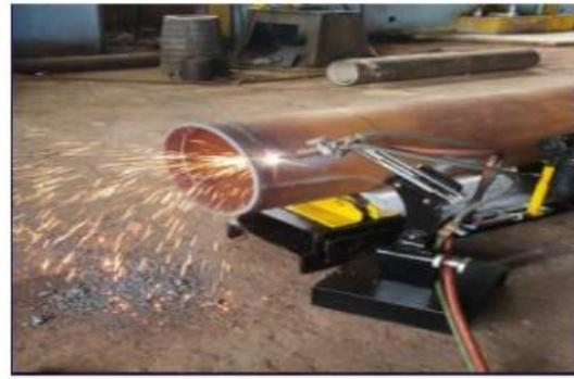
Sebelum Implementasi : Pemotongan pipa menggunakan pemotong otomatis
