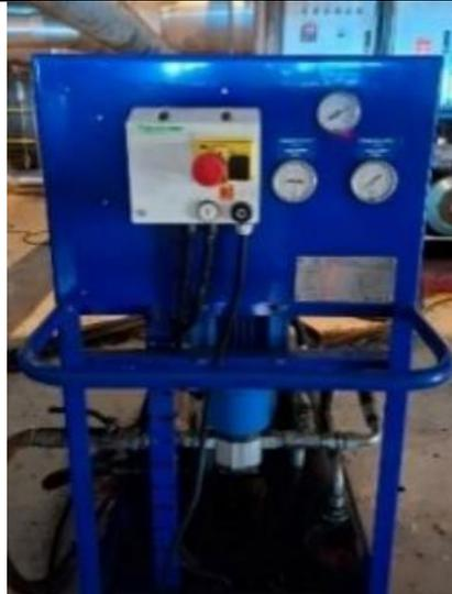
Gambar . Implementasi integrasi unit filter pada tangki oli elektro hidrolik
